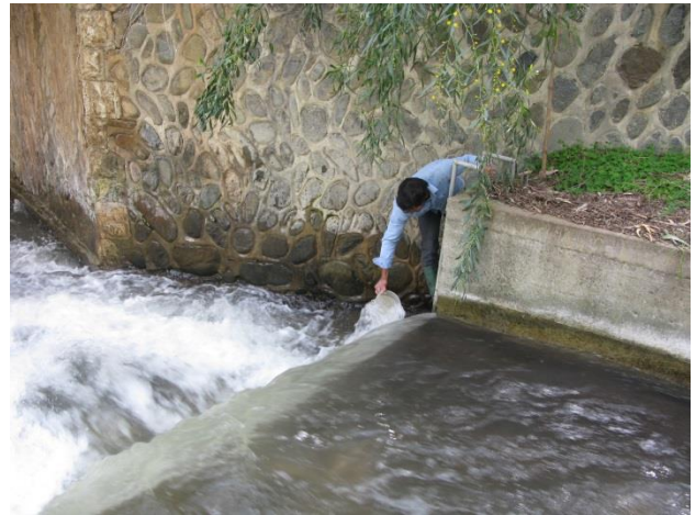
Δειγματοληψία υπόγειου νερού (αριστερά) και επιφανειακού νερού (δεξιά). Groundwater (left) and surface water (right) Sampling.
