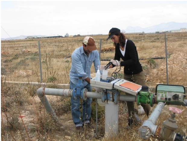
Δειγματοληψία υπόγειου νερού (αριστερά) και επιφανειακού νερού (δεξιά). Groundwater (left) and surface water (right) Sampling.
