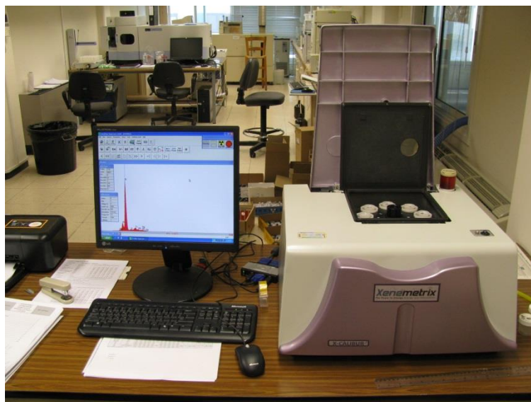
Φασματοσκόπιο φθορισμού με ακτίνες X για ανάλυση εδαφικών δειγμάτων X-ray fluorescence spectrometer for Soil analyses
