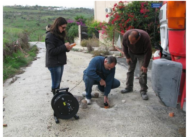
Εργασίες κλισιομέτρησης στη κατολίσθηση της κοινότητας Αρμου Landslide monitoring at Armou landslide area.
