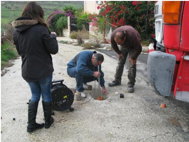
Εργασίες κλισιομέτρησης στη κατολίσθηση της κοινότητας Αρμου Landslide monitoring at Armou landslide area.
