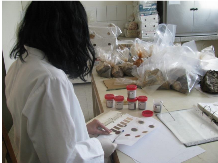
Χαρακτηρισμός φυσικών χρωστικών ουσιών με χρωματολόγιο Munsell Colour characterization of natural pigment using a Munsell colour scale
