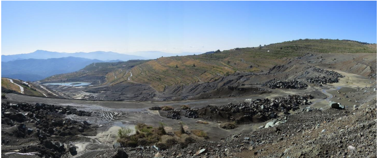
Απεικόνιση μέρους του κεντρικού κρατήρα του μεταλλείου Αμιάντου όπου φαίνεται μέρος των εργασιών αποκατάστασης και αναδάσωσης.
