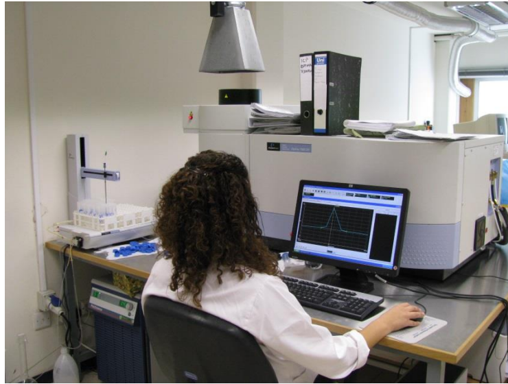
Μετρήσεις σε νερά με φασματοσκόπιο επαγωγικά συζευγμένου πλάσματος Water analysis with an Induced Coupled Plasma Spectrometer
