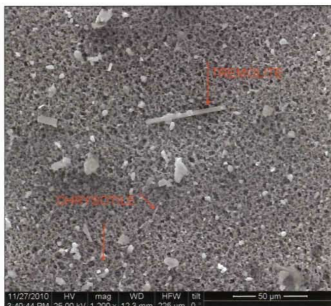
Εικ. 4: Φωτομικρογραφία ηλεκτρονικού μικροσκοπίου σάρωσης όπου φαίνονται ίνες χρυσωτιλικού και τρεμολιτικού αμιάντου σε μεμβράνη φίλτρου αέρα από τις μετρήσεις της ποιότητας του ατμοσφαιρικού αέρα.
