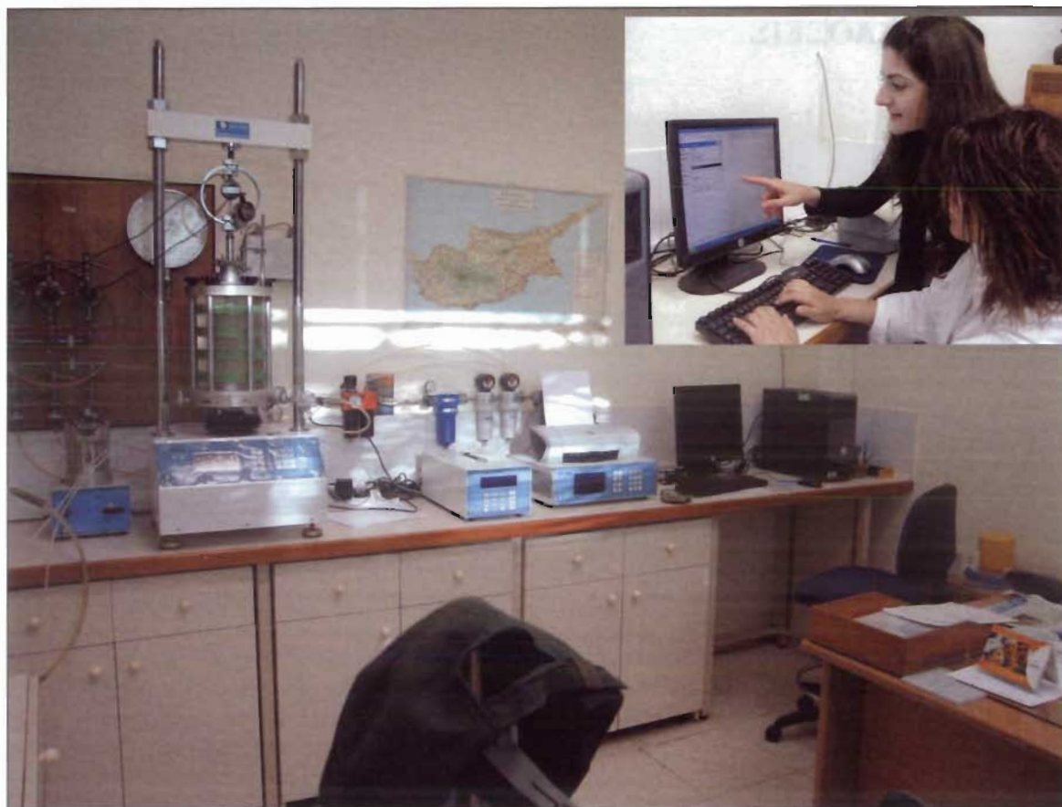
Εικ. 22: Διεξαγωγή Τριαξονικής Δοκιμής. Fig. 22: Triaxial test.
