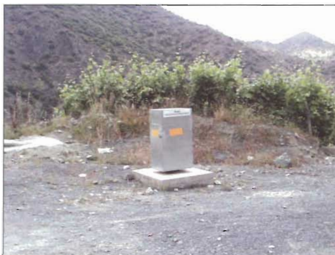
Εικ. 6: Αναβάθμιση σταθμών παρακολούθησης υπόγειου νερού σε τηλεμετρικούς. Fig. 6: Upgrading groundwater monitoring stations to telemetric.
