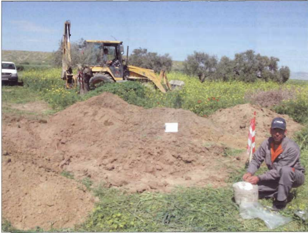
Εικ. 13: Δειγματοληψία εδάφους για εργαστηριακές δοκιμές για μελέτη οδοποιίας. Fig. 13: Soil sampling for laboratory testing – road works study.
