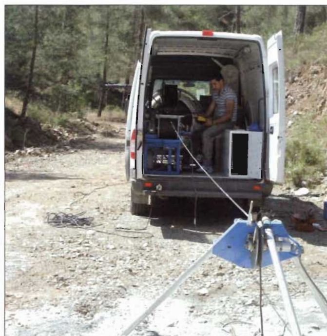
Εικ. 10: Ανόρυξη παραγωγικής γεώτρησης – Διεξαγωγή γεωφυσικών διαγραφιών σε γεώτρηση. Fig. 10: Drilling a water supply production borehole and performing geophysical logging of a borehole.
