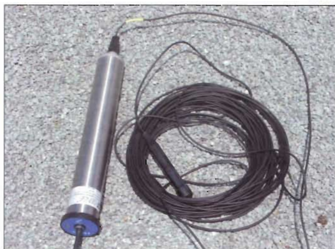
Εικ. 6: Αναβάθμιση σταθμών παρακολούθησης υπόγειου νερού σε τηλεμετρικούς. Fig. 6: Upgrading groundwater monitoring stations to telemetric.
