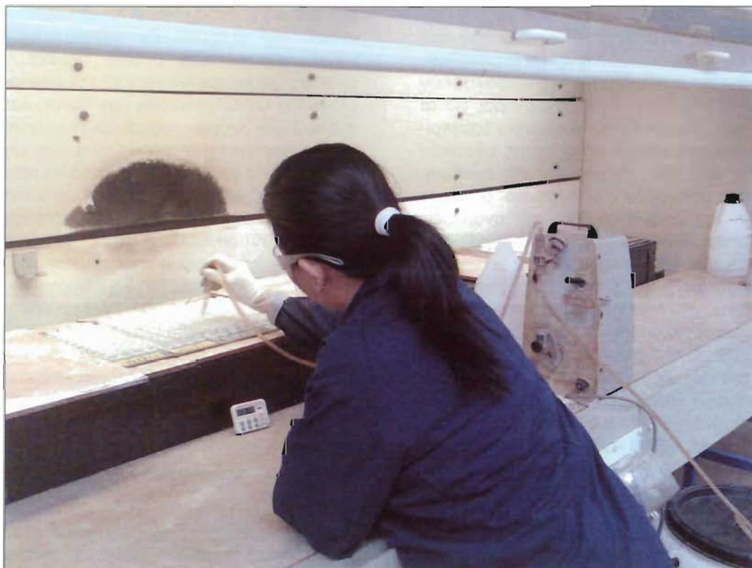
Εικ. 21: Ταυτόχρονη διάσπαση εδαφικών δειγμάτων με μείγματα πυκνών οξέων. Fig. 21: Simultaneous digestion of soil samples using strong acid leaching
